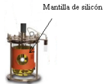
Figura 4. Tanque con control de temperatura empleando mantilla de silicón
