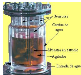
Figura 6. Bioreactor comercial con camisa de agua para control de temperatura.
