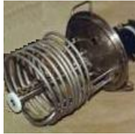
Figura 3. Serpentín para control de temperatura en un bioreactor comercial
